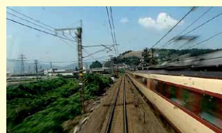
敦賀手前の交直セクションを通過中。列車は惰性で走っている。
